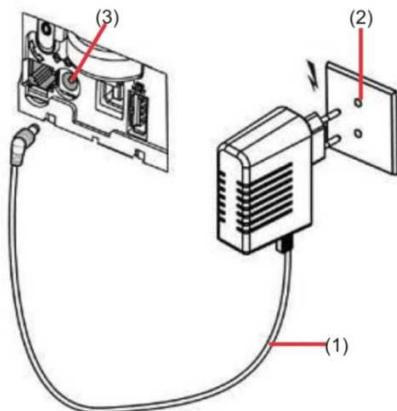
Nakon uklanjanja poklopca na poleđini terminala, uključite strujni adapter (1) u izvor napajanja električnom energijom (2), a drugi kraj uključite u označeni strujni konektor na terminalu (3 - Power).
